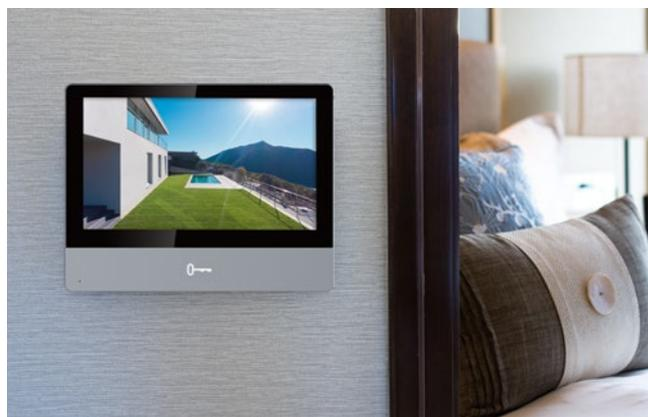
Los monitores cuentan con entradas y salidas de alarma configurables, que pueden conectarse a sensores de diferente naturaleza, como contactos magnéticos, alarmas de pánico, detectores de inundación y seguridad (humo y monóxido de carbono). Los eventos de alarma se pueden gestionar con notificaciones automáticas a la APP de Hik-Connect y al software iVMS-4200.
